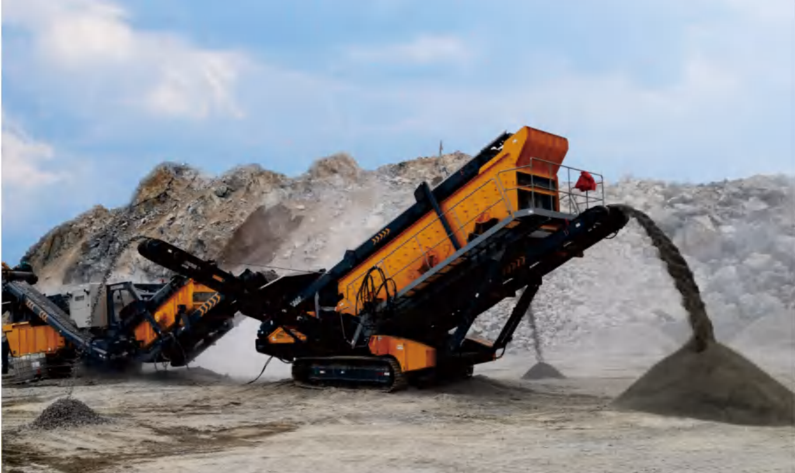
Main Technical Parameters Основные технические характеристики Crawler mobile jaw crusher
